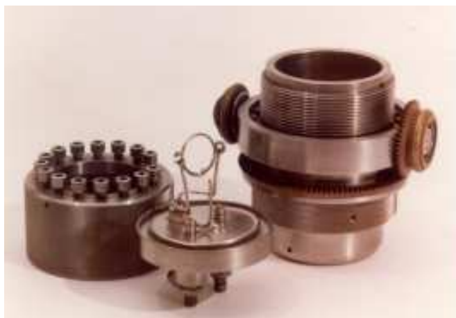
Figure 5 : bombe calorimétrique avec ces éléments.
