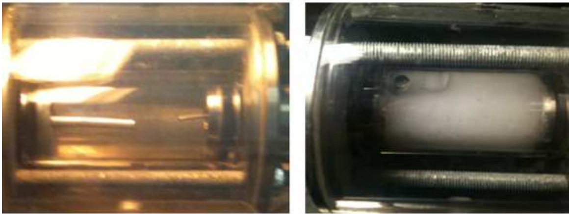
Figure IV.2. Solution de TBPB (concentration initiale de 10 % mas.) à gauche et l'aspect d'un coulis d'hydrates de TBPB (taux volumique d'hydrate de 18,9 % mas.)
